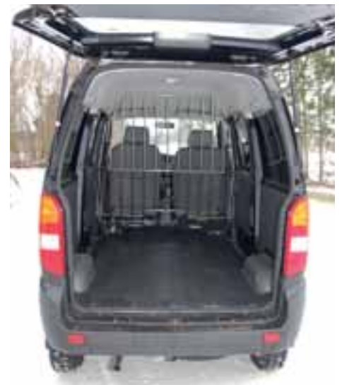
Takhängd bakdörr. Viss inredning härstammar från den personbilsregistrerade versionen. Sex små lastsäkringsöglor i golvet och belysning i taket. Skåpvolymen är ca 3,2 kubikmeter men maxlasten låga 493 kilo.
