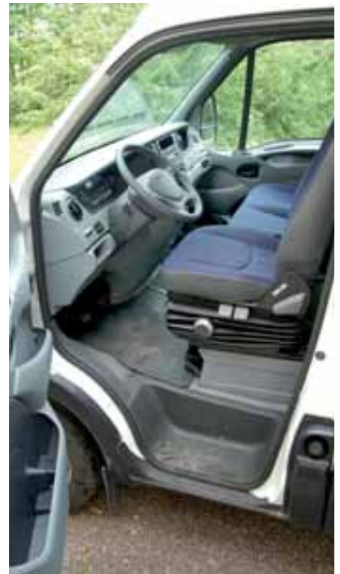
Högt men okomplicerat insteg till en förarplats med fjädrande och i höjddled justerbar förarstol. Instrumenteringen är överskådlig och reglagen åtkomliga.
