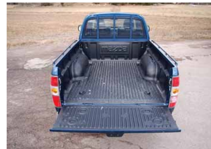
Flaket på Freestyle är 175,3 cm långt. Plastbaljan, som är standard i Sverige, är lätt att spola ren. Fyra lastsäkringsöglor i golvet och sex alldeles för små på sidorna. Lastsäkring även på lämmarnas utsida.
