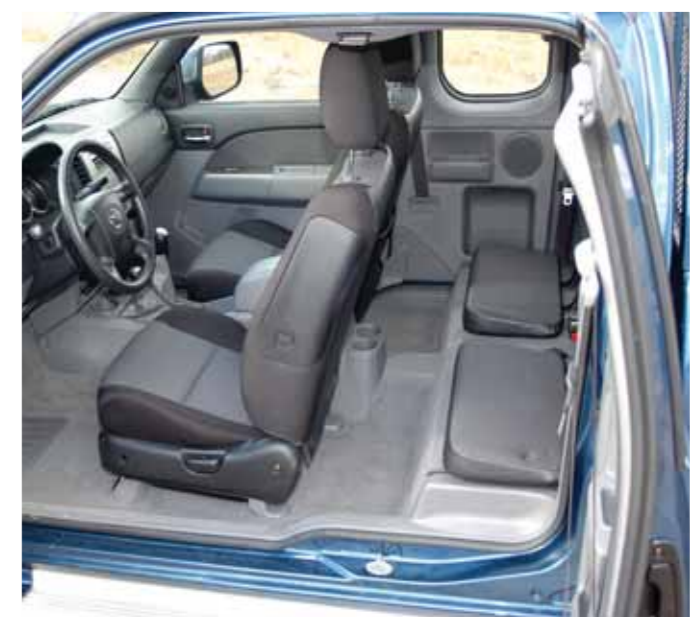
Bra förarplats med brister i inställningsmöjligheterna. Överskådliga instrument och åtkomliga reglage. Avsaknaden av B-stolpe ger god åtkomlighet till ett oanvändbart nödsäte som istället blir ett utmärkt bagageutrymme.
