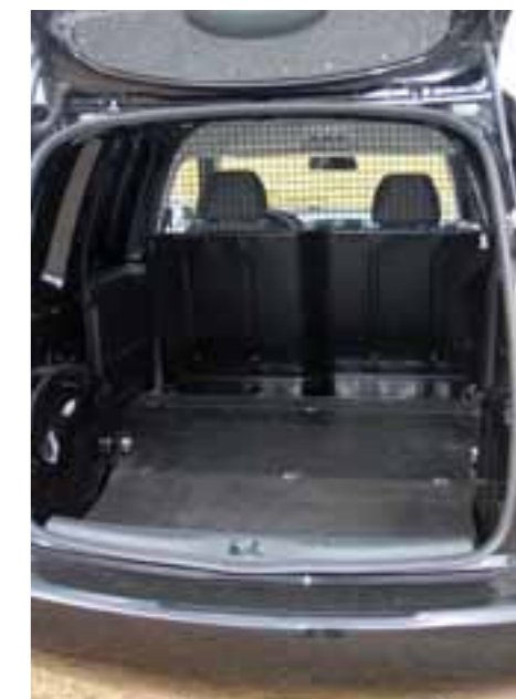
Eftersom inredningen plockats bort och mellanväggen inte är ljudisolerande blir åkturen bullrig. Golvet är en kompromisslösning. Tröskel bak att lyfta över. De sex säkringsöglorna är i minsta laget.
