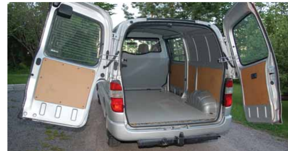
Sidohängda bakdörrar som tillval vilka öppnar från 90 till 180 grader. Hyfsad genomsikt med stor ruta i mellanväggen och rutor med torkare i bakdörrarna. Båda sidorna har lättgående skjutdörrar.
