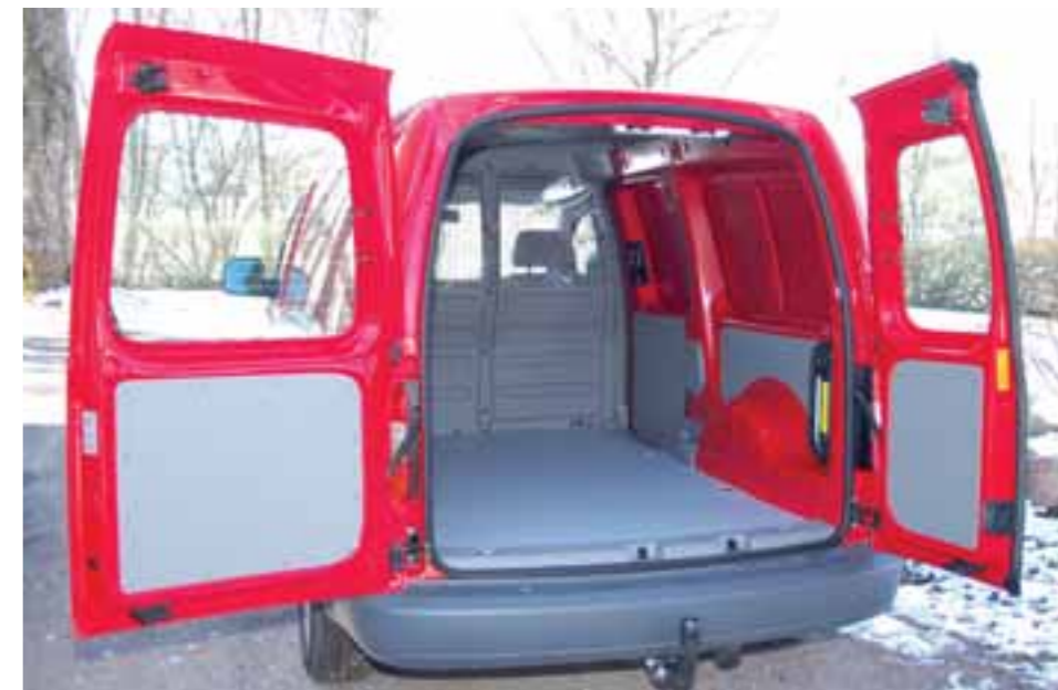
Asymmetriska sidohängda glasade bakdörrar med torkare på den vänstra. Låg lasthöjd till ett lättåtkomligt och belyst utrymme. Trägolvet är tillval.
