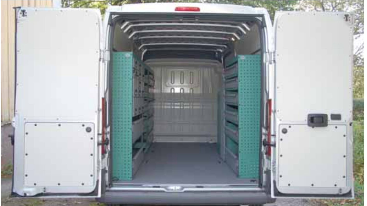
Sidohängda bakdörrar som gapar stort, men som inte spärrar i 180 grader. 270 graders öppning är tillval. Låg lasthöjd. Som standard är skåpet plåttrent. Inredningen är tillval från System Edström.
