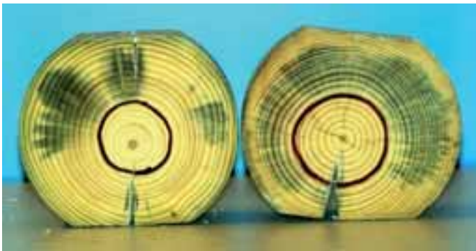
Inget roligt byggtimmer. I alla fall om man vill att det ska överleva några år. Rena fusket. Det gröna är blåsvamp.
