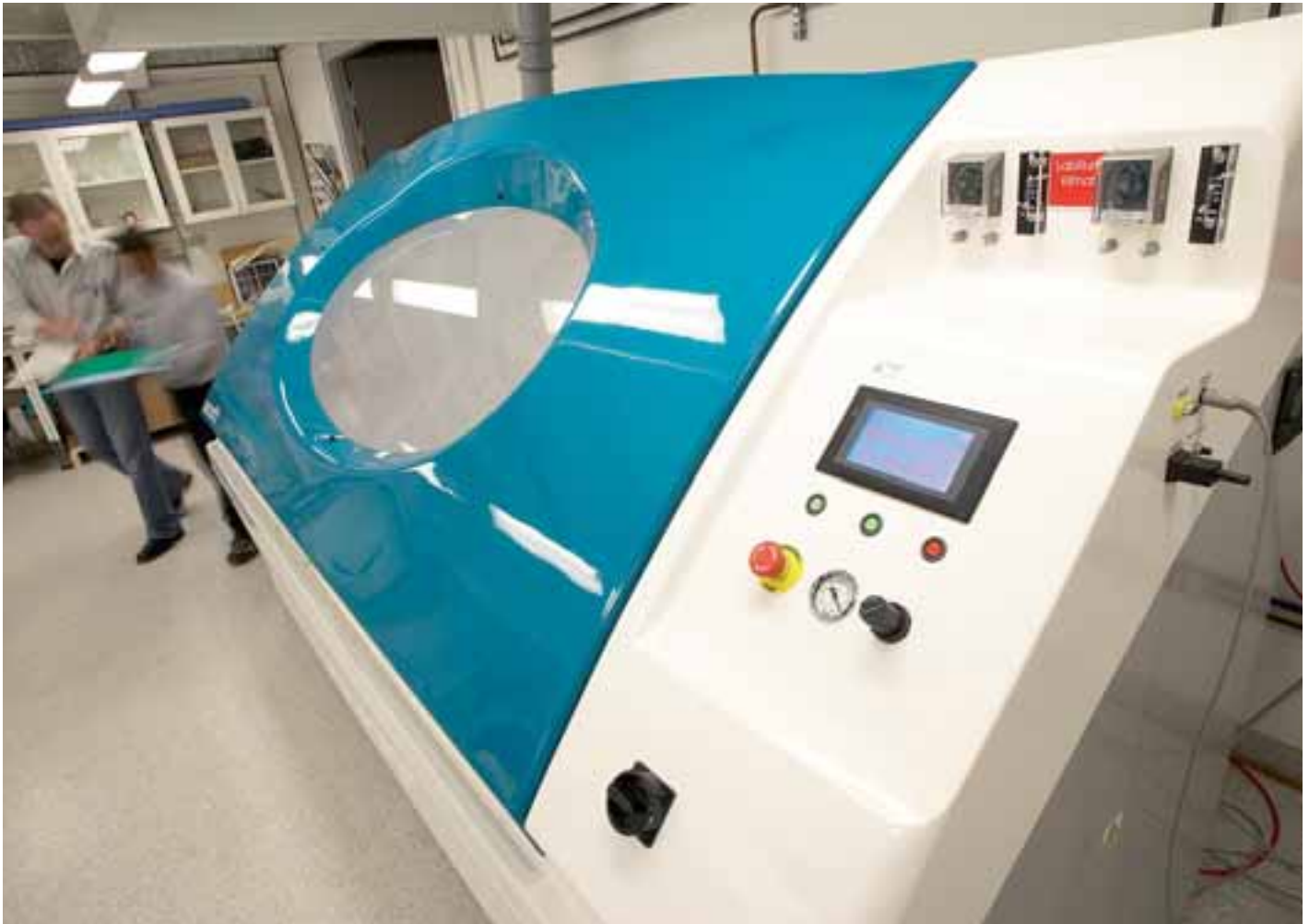
Skruttestet genomfördes under tio veckor i en korrosionskammare av det här slaget. Den här typen av korttidstest kritiserats av flera fabrikanter.
