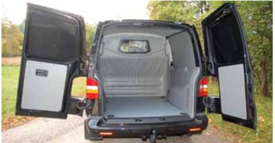
Det 190 centimeter långa skåputrymmet är endast åtkomligt bakifrån. Hardboardskiva på golvet med sex kraftiga öglor. Helt inklätt skåputrymme är tillval.
