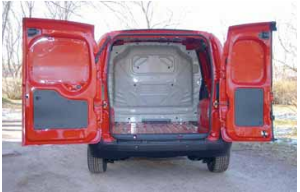
Asymmetriska fönsterlösa bakdörrar som tyvärr inte spärras när de öppnas i 180 grader. Plåttrent utom på dörrarnas nederkant. En smal sidodörr är tillval och komfortmellanväggen stjälar cirka 15 centimeter av öppningen.
