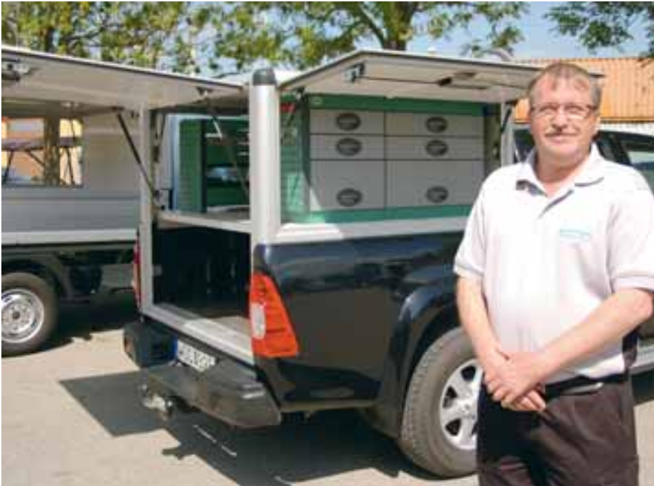
En enklare variant. Här utnyttjar man det befintliga flaket, som för övrigt kan bli mer åtkomligt med en utdragbar lastsläde, samt en enklare System Edström-inredning ovanför. Den som visar är Christer Laurén på Irsta Skåp som utöver sina egna produkter även representerar både Edströms och Sortimo.
