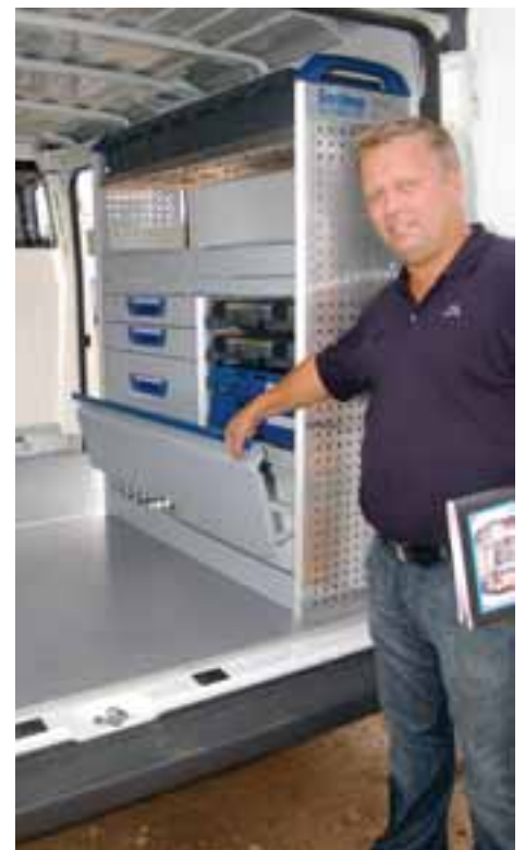
En enklare variant. Här utnyttjar man det befintliga flaket, som för övrigt kan bli mer åtkomligt med en utdragbar lastsläde, samt en enklare System Edström-inredning ovanför. Den som visar är Christer Laurén på Irsta Skåp som utöver sina egna produkter även representerar både Edströms och Sortimo.
