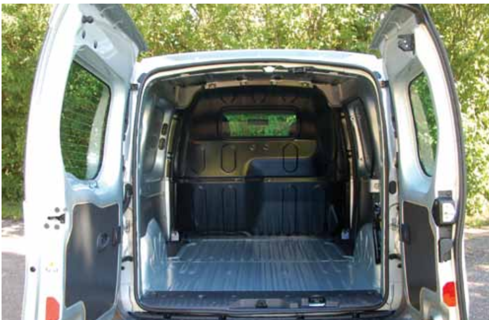
Lättåtkomligt lastutrymme via asymmetriska sidohängda dörrar vilka tyvärr inte låser i 180 grader. Inredning är tillval och de sex lastsäkringsöglorna är i minsta laget.
